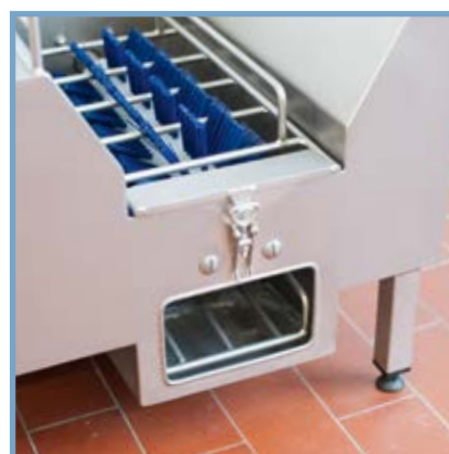
Oddzielne czyszczenie spodów i górnej części obuwia Separate cleaning of soles and uppers
